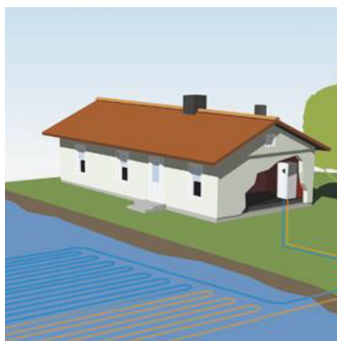
Obr. 10 Tepelné čerpadlo typu zem – voda (studňa) [5]
