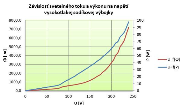
Obrázok 7. Závislosť svetelného toku a výkonu na napätí vysokotlakovej sodíkovej výbojky
