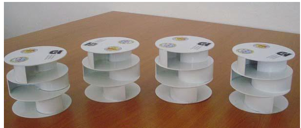
Obr. 4. Trojstupňové Savoniusove rotory s presahom lopatiek 0, 1, 2 a 3 cm
