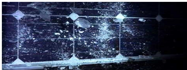
Obr. 3. Poškodenie FV panelu vplyvom búrkovej činnosti ( http://connect2solar.com.au )
