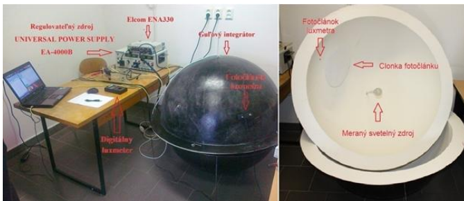
Obrázok 2. Meranie svetelného toku v guľovom integrátore
