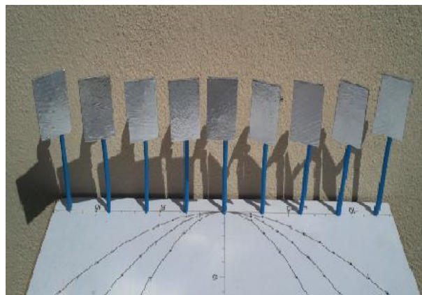
Obr. 2. Modely heliostatov rozmiestnené na priamke
