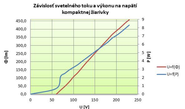
Obrázok 5. Závislosť svetelného toku a výkonu na napätí kompaktné žiarivky
