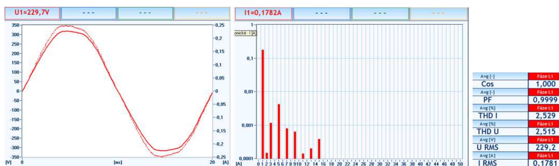
Obr. 32 Výsledky merania kvality elektriny pri záťaži: klasická žiarovka Osram, 40 W
