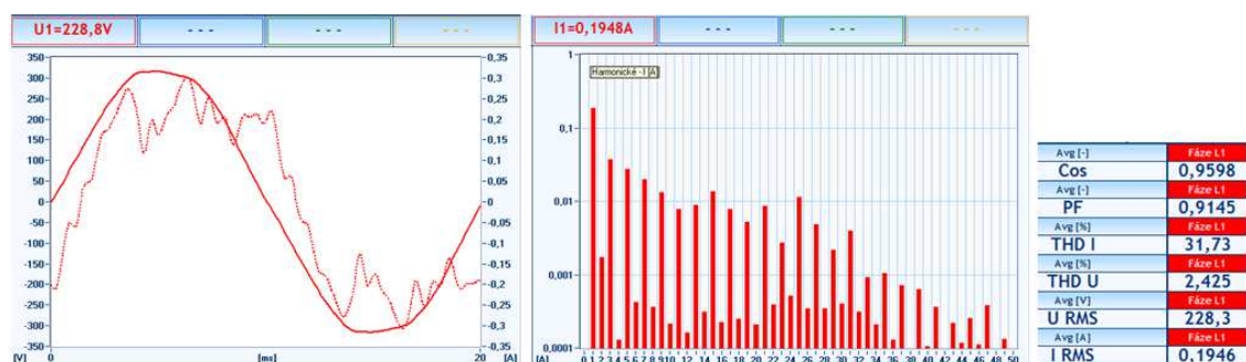
Obr. 37 Výsledky merania kvality elektriny pri záťaži: lineárna žiarivka Radium Spectralux L 36/840
