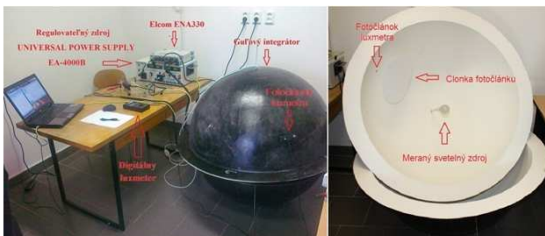
Obr. 21 Meranie svetelného toku v guľovom integrátore
