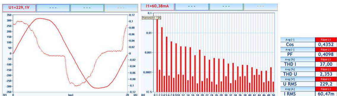
Obr. 35 Výsledky merania kvality elektriny pri záťaži: LED svetelný zdroj, COB 5 W
