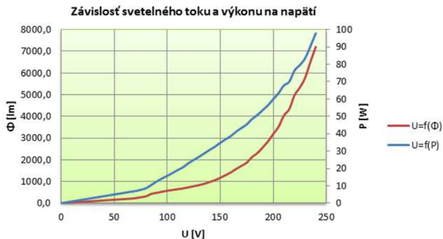
Obr. 26 Závislosť svetelného toku a výkonu na napätí vysokotlakové sodíkovej výbojky Osram NAV T 70W
