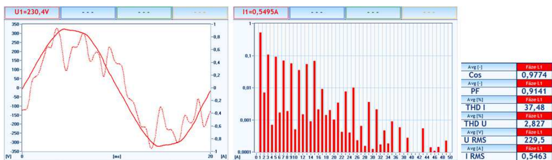
Obr. 39 Výsledky merania kvality elektriny pri záťaži: halogenidová výbojka Osram HCI T 100W/942 NDL
