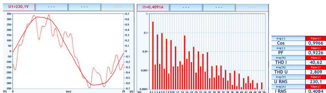
Obr. 36 Výsledky merania kvality elektriny pri záťaži: vysokotlaká sodíková výbojka Osram NAV T 70W
