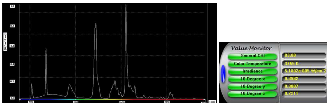
Obr. 48 Spektrálna charakteristika a svetelnotechnické parametre svetelného zdroja: lineárna žiarivka Radium Spectralux L 36/840
