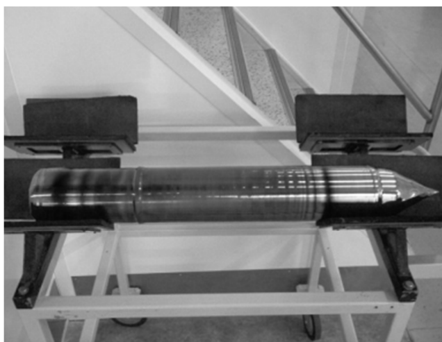
Obr. 2 Monokryštalický kremík - kmeňové rezivo
