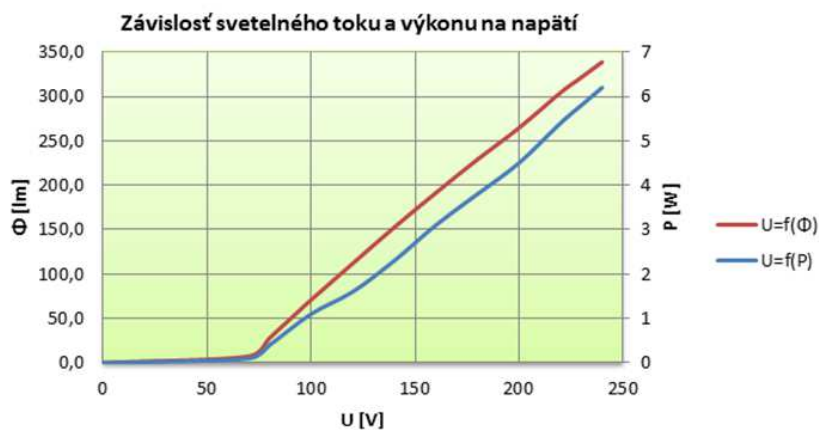
Obr. 25 Závislosť svetelného toku a výkonu na napätí svetelného zdroja LED COB 5W
