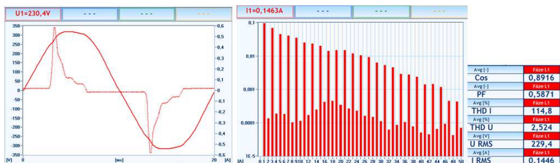
Obr. 40 Výsledky merania kvality elektriny pri záťaži: kompaktná žiarivka Osram DIE 18W/840
