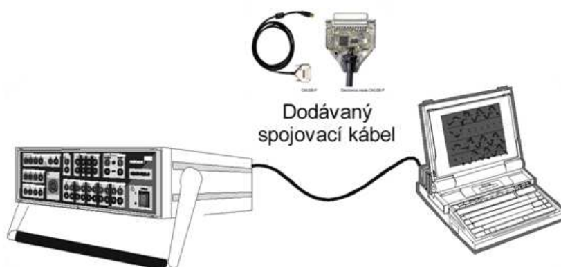
Obr. 11 CMC 156 prepojený s PC cez špeciálny kábel
